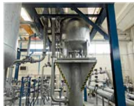
I serbatoi con bilance elettroniche e valvole di svuotamento.
